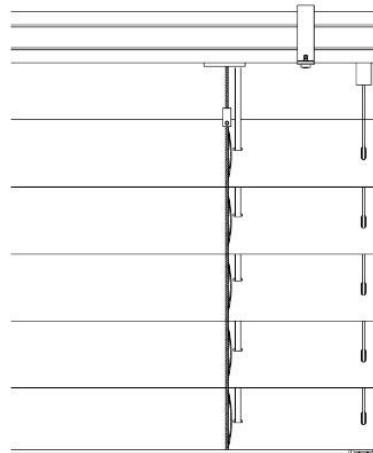
Fig. 2 - Ghidaj lateral cu cabluri oțelite
