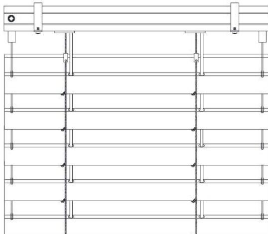
Fig. 2 - Ghidaj lateral cu cabluri oțelite
